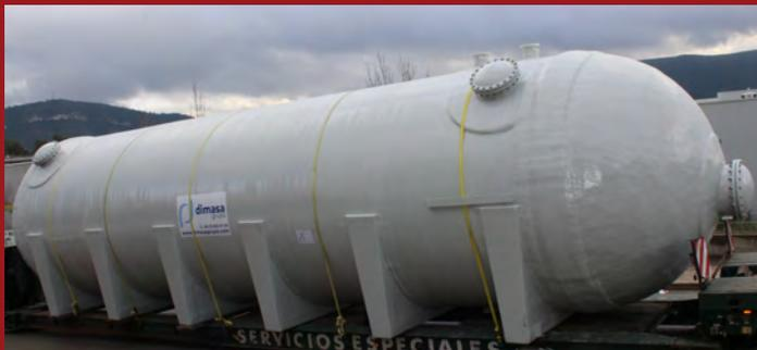
Depósito con filtración de arena horizontal
