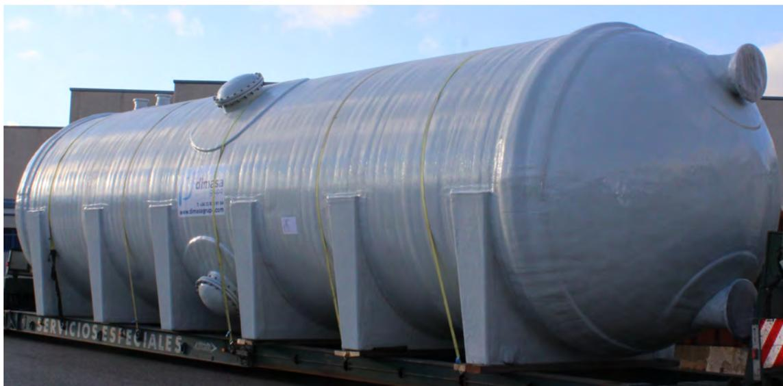
**Depósito con filtración de arena horizontal**
