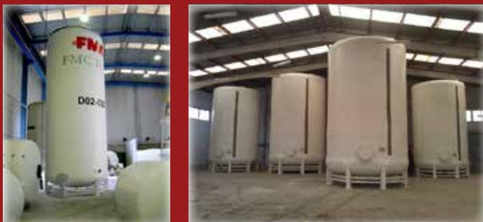
Depósitos verticales de superficie con fondo inferior toriésférico y superior toriésférico, plano o abierto.
